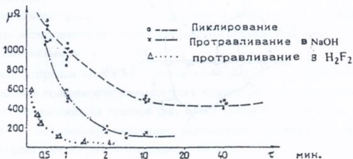
Рис.3.8. Зависимости поверхностного сопротивления образцов от времени протравливания.
