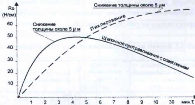
Рис. 3.9. Влияние времени протравливания на R_a
