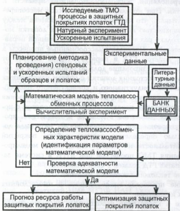
Рис.1. Методическая схема экспериментально-расчетного определения ресурса и оптимизации защитных покрытий лопаток ГТД.
