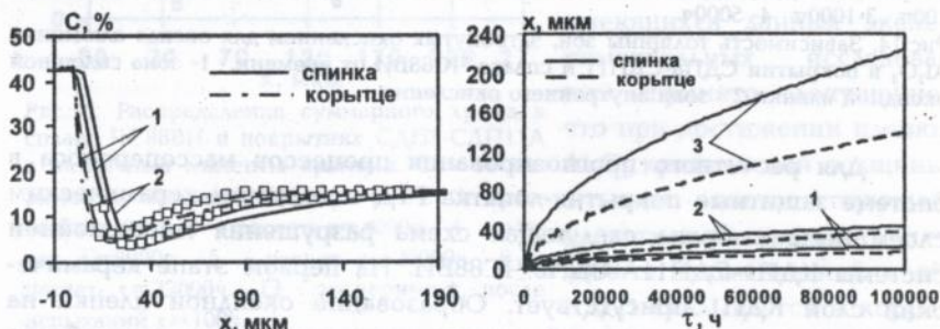
Рис.11. Распределение суммарного хрома на корытце и спинке лопатки из сплава ЭИ893 в различные моменты времени. \square - эксперимент \tau = 60000 \text{ ч} ; 1 - расчет, \tau = 60000 \text{ ч} ; 2 - расчет, \tau = 100000 \text{ ч} .
