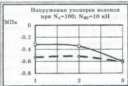
Мал.3 Порівняльний аналіз експериментальних та розрахункових значень нормальних та дотичних напружень у ортогональних хрестах із КДК
