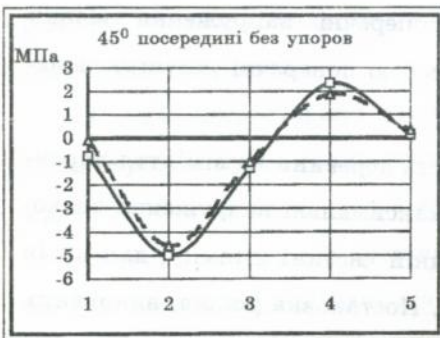
Мал.1. Епюри поперечних напружень зім'яття при кутах нахилу волокон 90° 45° (рівень навантаження 15кН) з упорами та без них.
