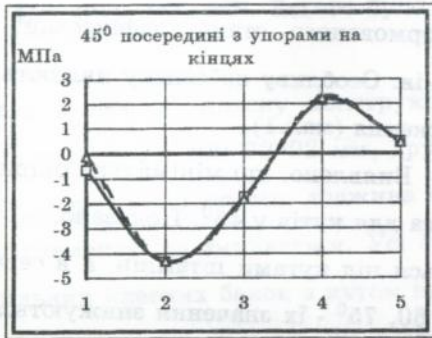
Мал.1. Епюри поперечних напружень зім'яття при кутах нахилу волокон 90° 45° (рівень навантаження 15кН) з упорами та без них.
