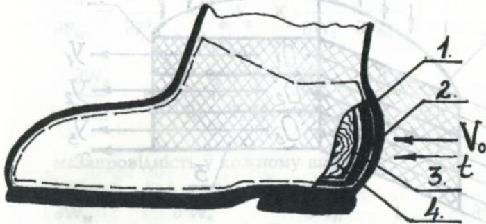
Рис. 1. Схема п'яtkового вузла під дією сушильного середовища ( t^{\circ}\text{C} - температура сушильного агента; V_0 - швидкість повітря).
