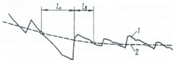
Рис.4- Определение положения нейтральных линий в слоях:1- кривая фактических оседаний; 2- сглаженная кривая оседаний
