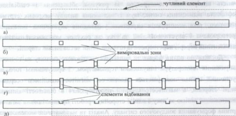
Рис.1. Варіанти виконання чутливих елементів ультразвукових імпульсних термометрів
