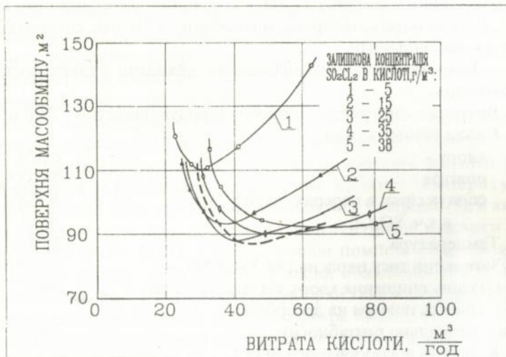
рис.4. Зміна поверхні масообміну в залежності від витрати кислоти
