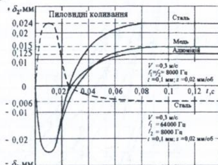
Рис. 7. Вплив матеріалу деталі на час перехідного процесу
