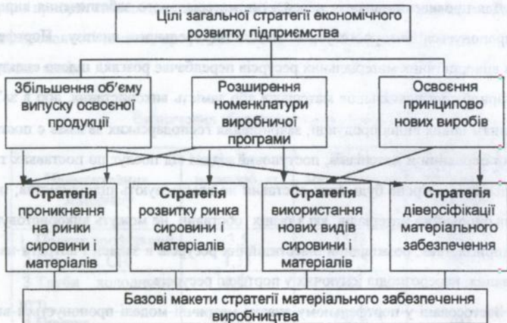
Мал. 2 Взаємозв'язок стратегії матеріального забезпечення виробництва з цілями загальної стратегії економічного розвитку підприємства.
