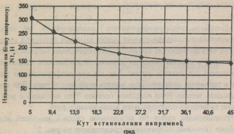
Рис. 3. Графік залежності результуючої реакції бічної напрямної від кута \beta при габаритній площі накопичувача 1\text{ м} \times 0,8\text{ м} , діаметрі пляшок 0,071\text{ м} і коефіцієнті тертя 0,2 .
