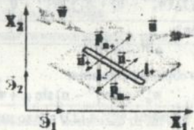
Рис.5. Модель силової взаємодії контуру з потоком стисливого середовища
