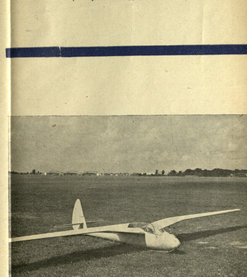
Nowy polski dwumiejscowy szybowiec wyczynowy „Mewa”, konstrukcji inż. A. Kocjana. Rozpiętość skrzydeł 17 m.
