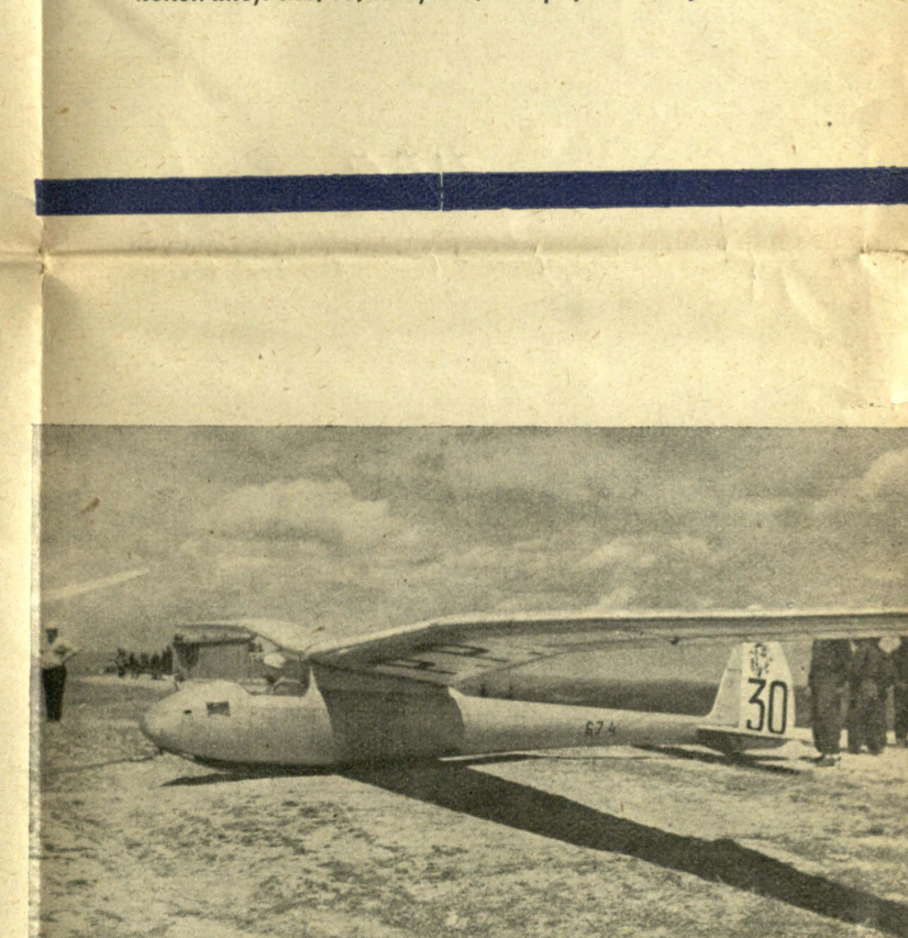
Szybowiec wyczynowy typu S. G. -3 bis/36 konstr. inż. Szczepana Grzeszczyka. Zwraca uwagę charakterystyczne załamanie skrzydeł, zapewniające dobre zachowanie się szybowca w krzywiznach.
