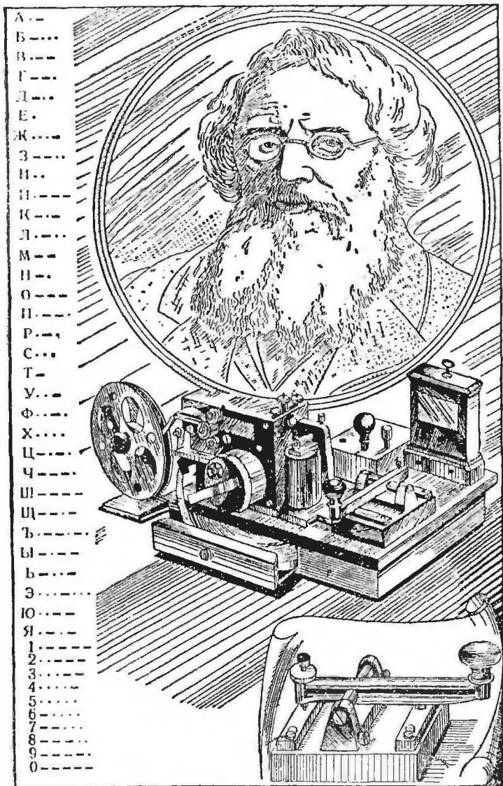
Сэмюэль Морзе, его телеграфный аппарат, ключ и азбука.
