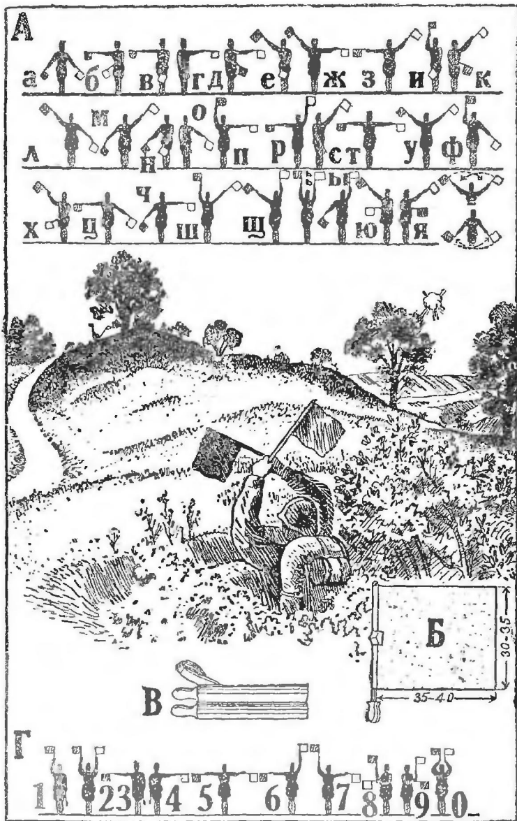
Как передают сигналы флажками: А — азбука семафора, Б — сигнальный флажок, В — два флажка в чехле, Г — условные сигналы цифр.
